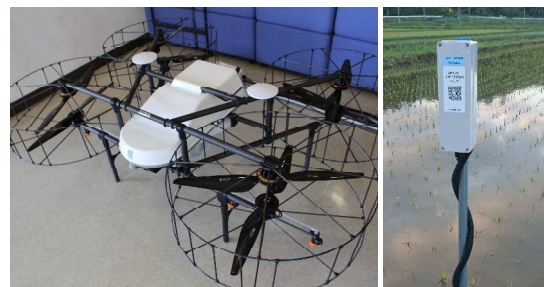
実際に使用する「ドローン」と「水位センサー」
