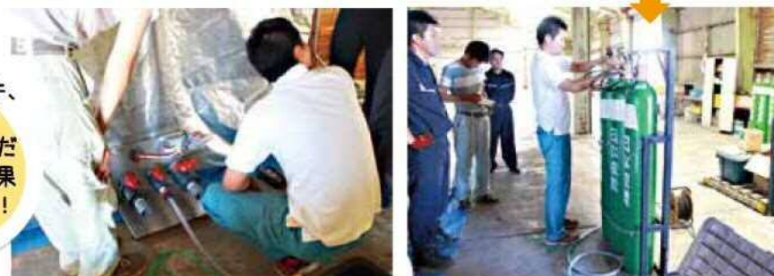
③ 炭酸ガスの栓を開けます ④ 管を通して部屋の中に炭酸ガスを入れ、殺虫します
