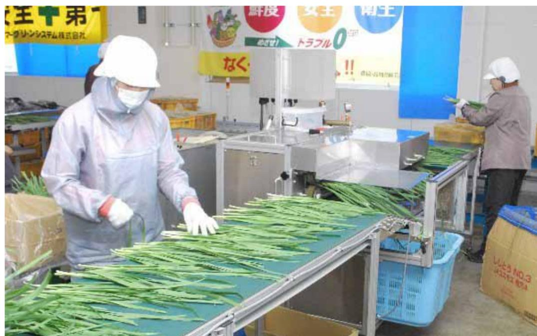
収穫後のニラを水圧を利用した「そぐり機」に流し込み=写真奥=さらに人の手できれいに整える(佐川町永野の「そぐり・計量結束センター」)
