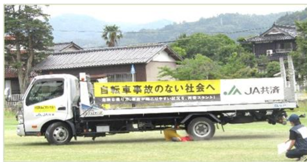
内輪差によるトラックの巻き込み事故の再現
