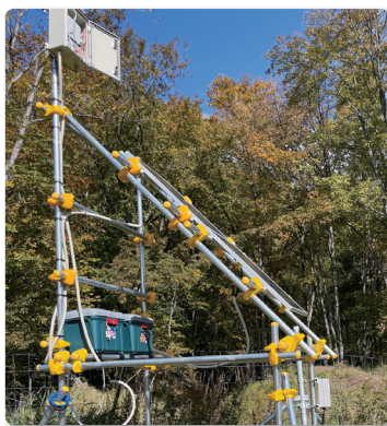
ほ場に設置した無線基地局（LoRaWAN ® ）で情報通信インフラを整備
