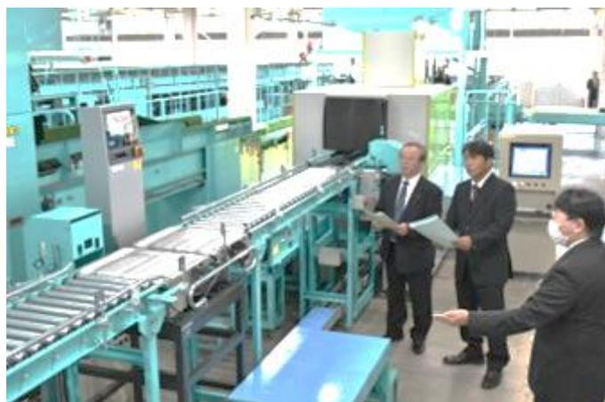
同選果場での選果機の更新は12年ぶり。今回は6つの選果工程を刷新した。外観判定では、これまでよりも解像度の高いカメラになり、台数も1台増の7台を設置。重量測定には、より高速で計測できる性能のものに変更した。今回から重量、内部品質、空洞検査の結果を総合的に判定して等級を決定するため、より安定した品質のスイカが消費者に供給される。
